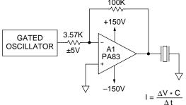
SIMPLE PIEZO ELECTRIC TRANSDUCER DRIVE
